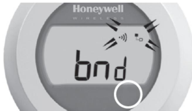
3. Con un buen estado de recepción, el LED
